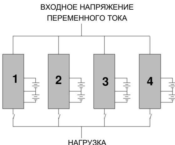
Рисунок 24 — Схема подключения изделий в систему параллельного резервирования.
