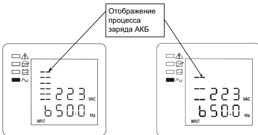
Рисунок 21 — ЖК-дисплей, форсированный (ускоренный) заряд АКБ
